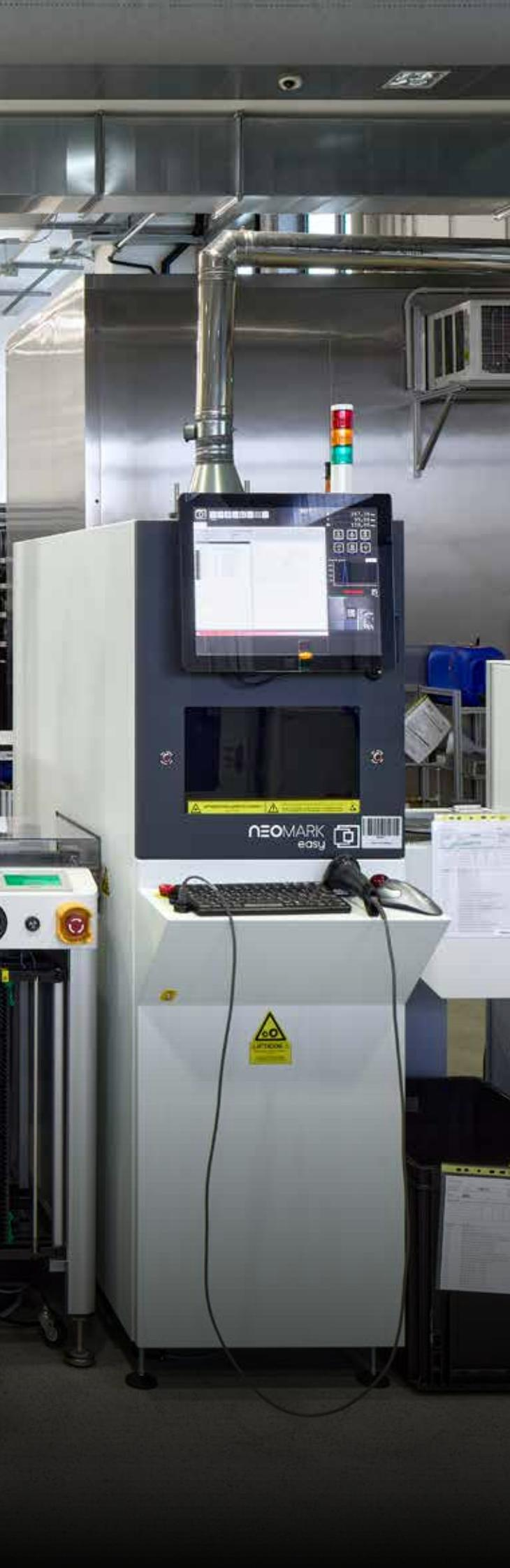
TEXA dispone di linee produttive avanzatissime, che implementano le più moderne tecnologie. Ad esempio, gli strumenti caratterizzati da una altissima densità di componenti, vengono assemblati in una nuova linea automatizzata SMT Fuji, le cui specifiche sono state sviluppate da TEXA stessa.
