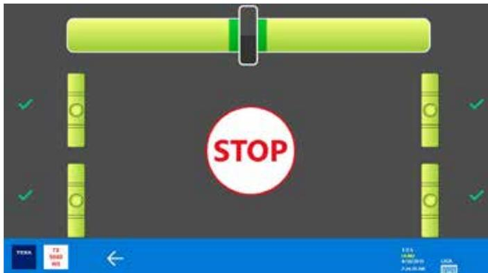
Il est nécessaire de positionner les 4 détecteurs CCD parallèlement à la surface de travail et de centrer la direction. Une fois ses conditions réunies, apparaît le logo « STOP ».
