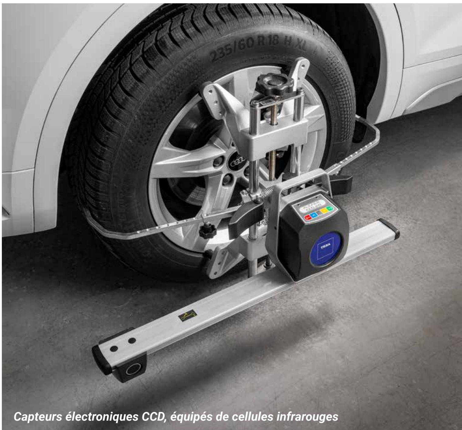
*Capteurs électroniques CCD, équipés de cellules infrarouges*
