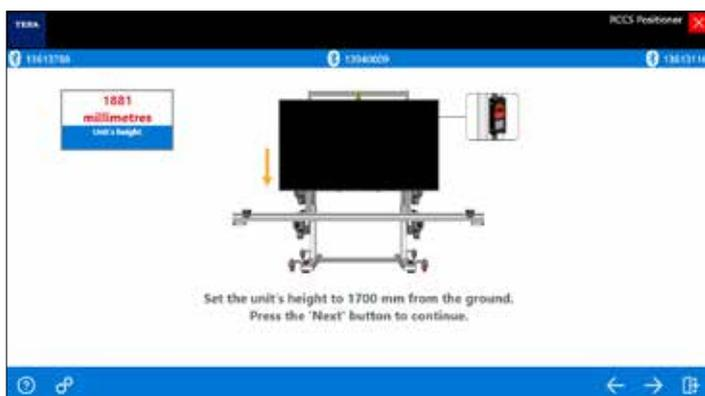
Déplacer la structure électriquement afin d'atteindre la hauteur optimale.
